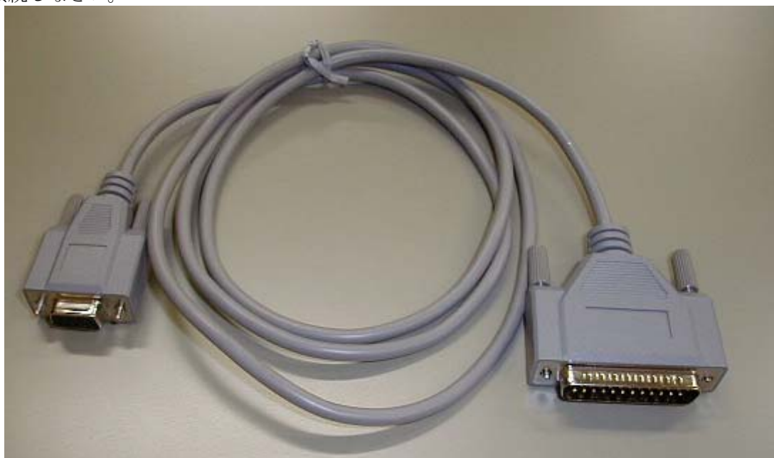
図 4. 2 パーソナルコンピュータと H8 を接続するシリアル通信ケーブル
