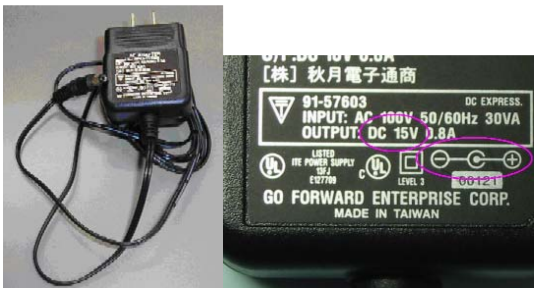
図 4. 3 AC アダプタ 「出力が DC 15V」であること、「端子センタが+」であることを確認
