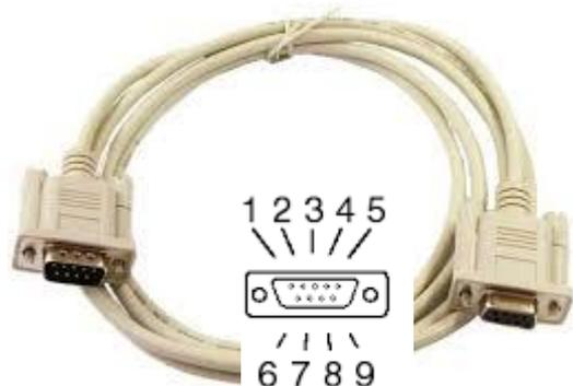
・外観は同じだが、内部の結線により、ストレートケーブルとクロスケーブルの2種類がある。PCとマイコンを接続する場合はストレートケーブルを用いる種類を間違えると通信できないので、**使用時には確かめて接続すること**
