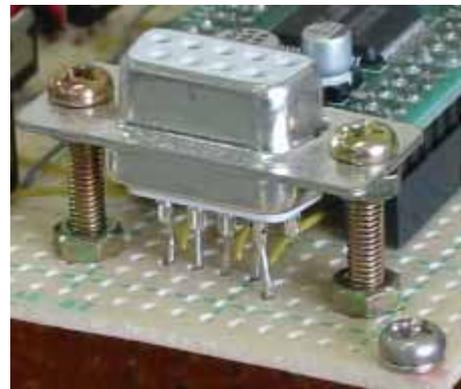
図 6. 5 DSUB9 の取り付けの工夫
