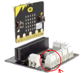
P8,P12でコントロールされるモータ出力端子
