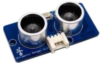
超音波距離センサ groveUltrasonicRanger
