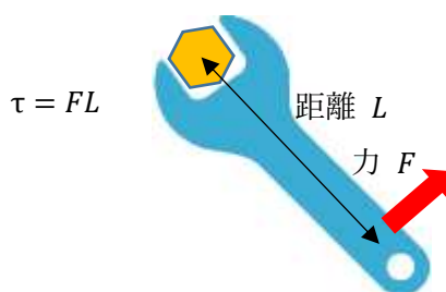
図 1 スパナでボルトの頭を回すときに生ずるトルク \tau
