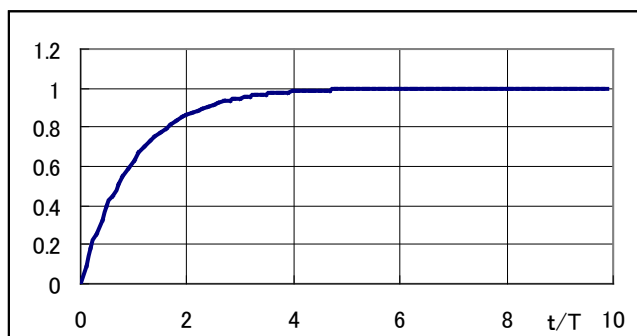
図6 RC回路の(一次遅れ系の)単位ステップ応答
